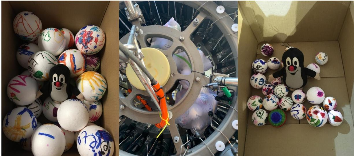
*Abb. 3: Der Maulwurf mit den Styroporkugeln (bevor (nachdem) sie an die CTD gebunden wurden links (rechts)), die bei 5°S auf 4200m Tiefe unter dem hohen Druck der Wassersäule geschrumpft sind. Foto: Joke Lübbecke*
