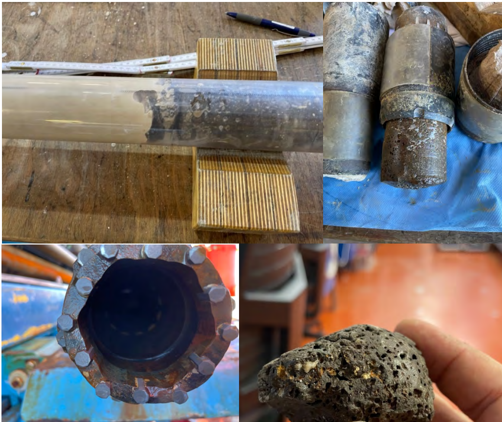
Abb.1: Unsere Innenbohrkrone mit Bohrzähnen nach dem Einsatz, Kern mit Sediment über „Basalt“, „Basalt“ im Core Catcher, und Handstück aus verwittertem vesikulären „Basalt“. Fotos: H Pälke
