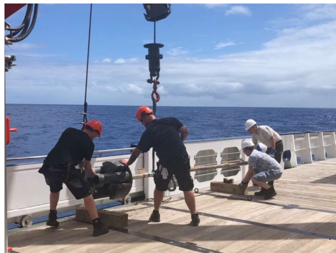
Abbildung 5: Bergung der Temperaturlogger von der Wärmegradientenlanze. (Foto: U. Röhl)
