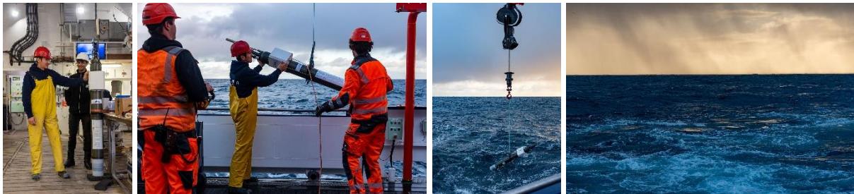
Eine Boje des internationalen ARGO-Programms zu dem Monitoring der Ozeane wird während der MSM111 ausgesetzt. Das Instrument wird zuerst mit einem Magnet eingeschaltet und dann mit Kran über Bord ausgesetzt, ehe es in den Wellen des Ozeans verschwindet. Photos: Volker Diekamp.
