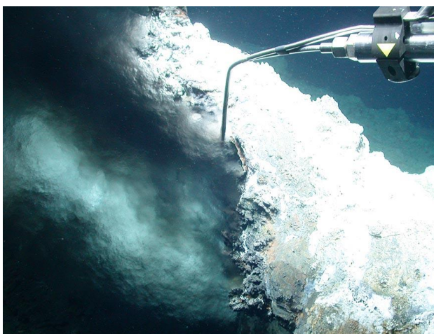
Abbildung 1: Die Temperaturmessung in der Ausstromöffnung des Schwarzen Rauchers zeigte, dass die Fluide mehr als 300°C heiß sind. Neben diesem aktiven Raucher haben wir zahlreiche inaktive und erloschene Raucher gefunden und beprobt.
