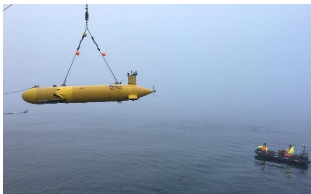
Abbildung 3: Nach einem langen Tauchgang wird das AUV SEAL 5000 am Morgen geborgen. Die See ist hier in der framstarße nahe der Eiskante völlig ruhig und erleichtert trotz dichten Nebels das Einholen mit dem Schlauchboot (@ Gerhard Bohrmann).
