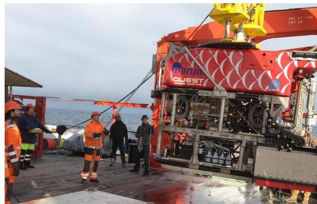
**Abbildung 2:** Aussetzen des MARUM ROV QUEST vom Achterdeck des FS MARIA S. MERIAN am frühen Morgen zum ersten Tauchgang der Reise bei wechselnder Wetterlage (© Gerhard Bohmann).
