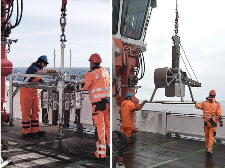
*Abb. 1: Bergung des Multicorers (links) und Einsatz des Kastengreifers (rechts) an einer Standardstation des LTER Observatoriums HAUSGARTEN.*
