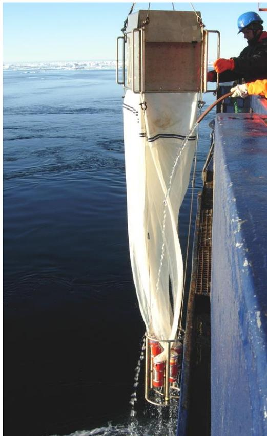
Fig. 3: Einsatz des Multinetzes zur Erfassung von Zooplankton-Organismen in definierten Wassertiefen der Wassersäule.
