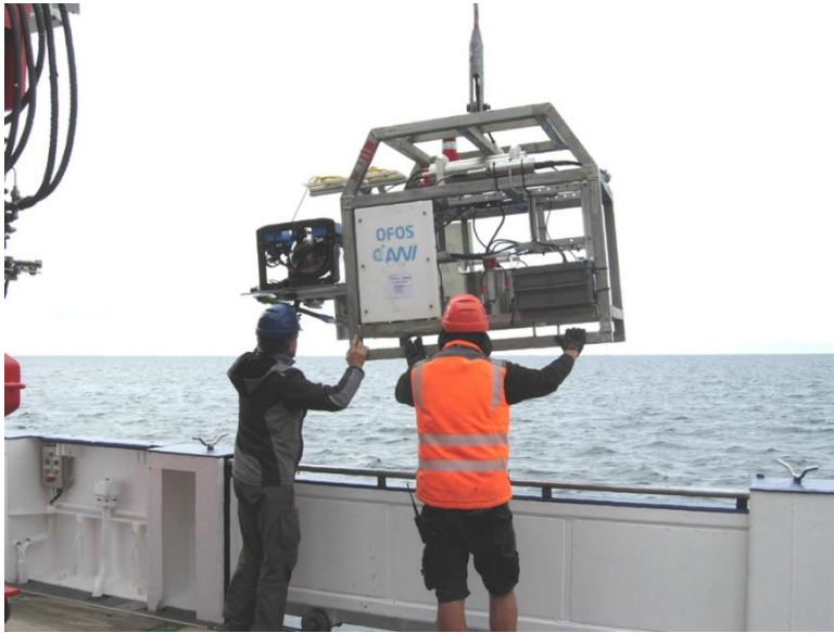
Abb. 3: Einsatz des geschleppten Foto/Video-Systems (Ocean Floor Observation System, OFOS) zur Kartierung des Meeresbodens und Erfassung der größeren Bewohner des Tiefseebodens.
