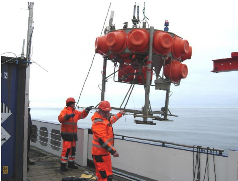
Abb. 1: Bergung des Langzeit-Freifallgeräts (Bottom-Lander) nach einem Jahr Standzeit an der zentralen Station des LTER Observatoriums HAUSGARTEN.
