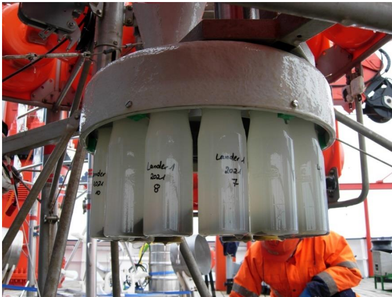
Abb. 2: Probenflaschen-Karussell der Sinkstofffalle zur Erfassung des auf den Tiefseeboden herabsinkenden partikulären Materials.
