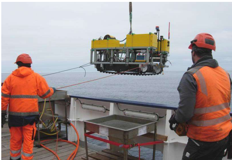
Abb. 3: Erster Test des neuen Meeresboden- Kettenfahrzeugs der AWI-Tiefseegruppe zur Erfassung von Remineralisierungsraten am Tiefseeboden.
