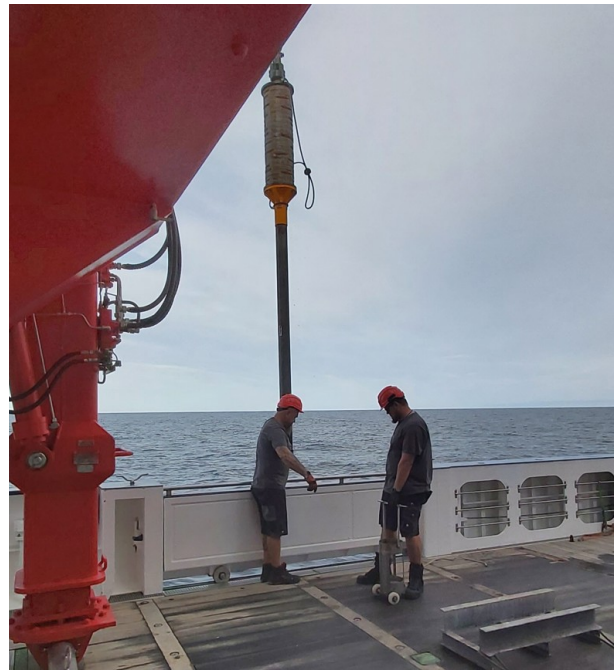
Abb. 5: Probennahme mit dem Schwerelot. (Foto: Sebastian Hölz)
