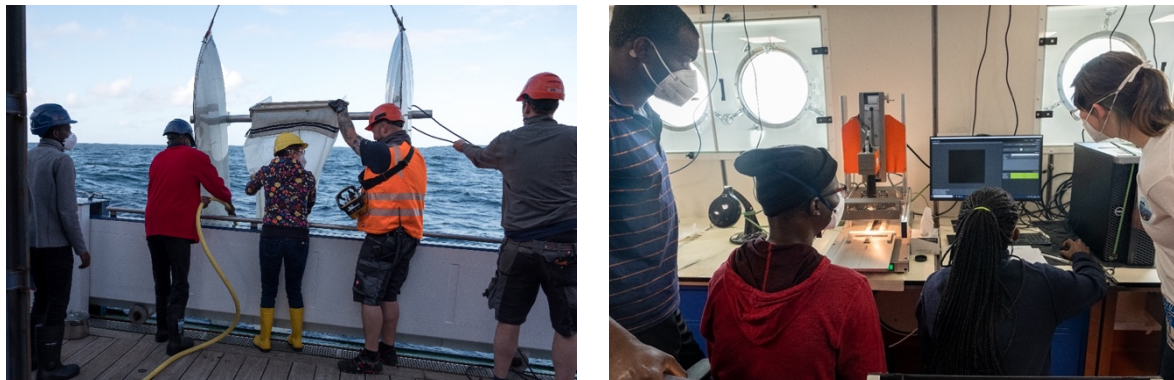
Abbildung 2, (S. Kaehlert): Einholen des Katamarans und Waschen der Probe in das „cod-end“ am Ende des Netzbeutel (links). Das „cod-end“ wird ausgetauscht und der Katamaran direkt wieder ausgesetzt. Gnillane Diouf aus dem Senegal bereitet die Mikroplastik Partikel für das Scannen mit der Hyperspektral-Kamera vor (rechts). Dieses bildgebende System erlaubt es bereits an Bord zu analysieren, ob es sich bei den auf der Oberfläche gefundenen Partikeln tatsächlich um Mikroplastikpartikel handelt.
