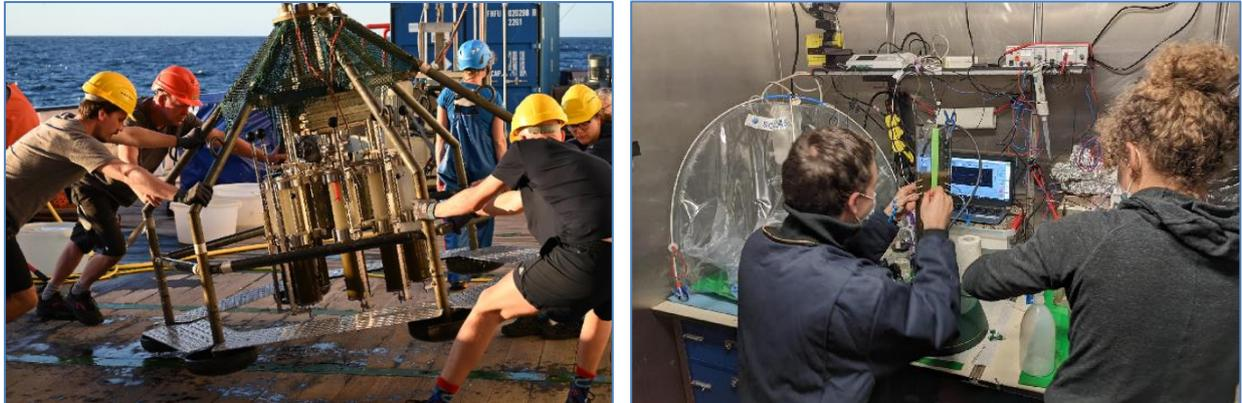
(Bild links: Michael Kossack, Andreas Wolff, Simon Pormann und Antonia Witzleb (von links) beim einholen des Multicorers mit gefüllten Kernrohren. Bild rechts: Jenny Fabian (rechts) und Michael Kossack (links) bei der Entnahme von Porenwasser mit Rhizonen aus einem Multicorer Kern im Kühlraum der MARIA S. MERIAN) (Fotos: Christian Meeske, Simon Pormann).
