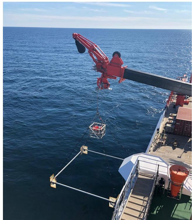
Abb. 1: CSEM Sender in der "CAGEM"-Konfiguration.
