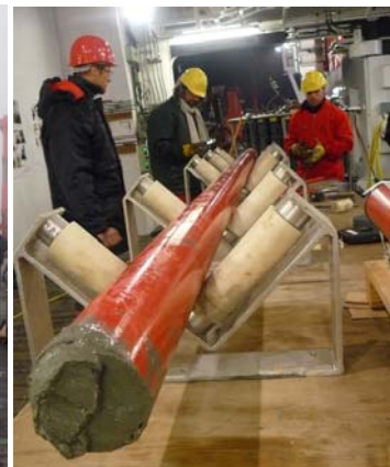
Das Sedimentbeprobungsprogramm in der Disko Bucht: Aussetzen des Schwerelots (links), Bearbeitung des gewonnenen Sedimentkerns (links).
