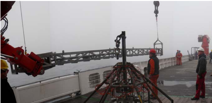
Das Sedimentbeprobungsprogramm in der Disko Bucht: Aussetzen des Schwerelots (links), Bearbeitung des gewonnenen Sedimentkerns (links).
