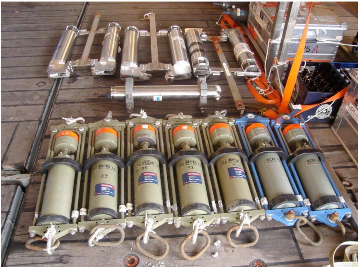
Aanderaa akustische Strömungsmesser (vorne), Argonaut Strömungsmesser (SonTek), und Auslöser (hinten) der drei Turbulenzverankerungen. Der Argonaut misst neben den horizontalen auch die vertikalen Geschwindigkeiten. Rechts im Bild sieht man die Flaschen für die Salinometerproben und Expeditionskisten.
