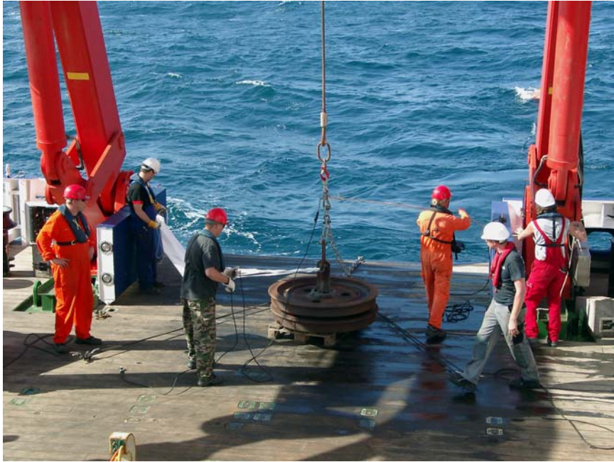
Aussetzen einer Sedimentfallen-Verankerung ca. 200nm vor Kap Blanc, Mauretaniien.
