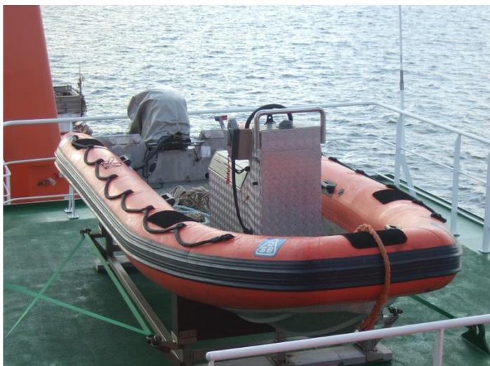
Das Schlauchboot ist mit einem 60 PS Yamaha-4-Takt-Außenbordmotor ausgestattet. Es wird auf dem Dach des Kammeranbaus hinter der Brücke an Backbordseite gelagert und kann mit dem Hilfskran Nr. 2 (Hangardach) schnell und einfach bewegt werden.
