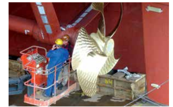
Die Phasen des Baus des FS SONNE: Planen, Konstruieren, Versuchen und endlich der Baubeginn. Gebaut wurden vorausgerüstete Blöcke, die im Baudock der Meyer Werft in Papenburg zum Ganzen zusammengefügt wurden. Nach der Montage der Propeller schwimmt das Schiff vor der Schiffbauhalle.
