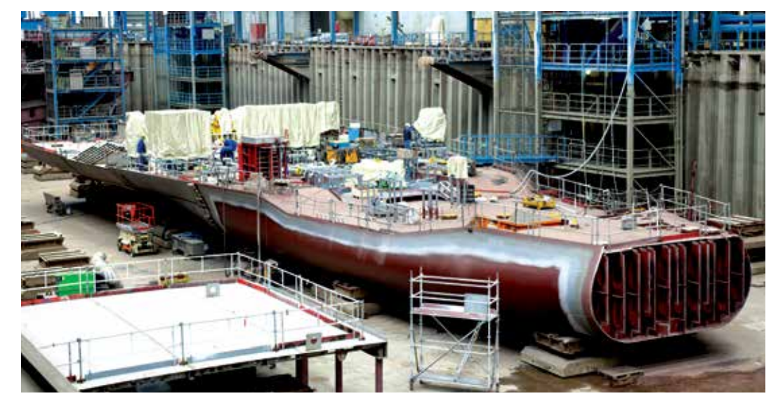
Die Phasen des Baus des FS SONNE: Planen, Konstruieren, Versuchen und endlich der Baubeginn. Gebaut wurden vorausgerüstete Blöcke, die im Baudock der Meyer Werft in Papenburg zum Ganzen zusammengefügt wurden. Nach der Montage der Propeller schwimmt das Schiff vor der Schiffbauhalle.
