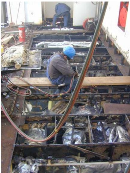
Stahlarbeiten in Luke 1 vor der Neuverlegung der Holzbeplankung
