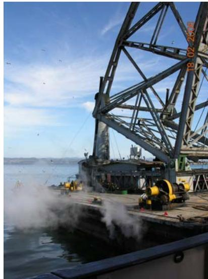
Vor dem Auslaufen zur See-Erprobung muss der 30 Tonnen schwere Kompressorcontainer an Bord genommen werden. Dazu wurde ein technisches Denkmal benötigt, der von Gustave Eiffel entworfene Kran ist über hundert Jahre alt. Er hat eine Tragkraft von 400 Tonnen und wird mit Kohle und Dampf betrieben
