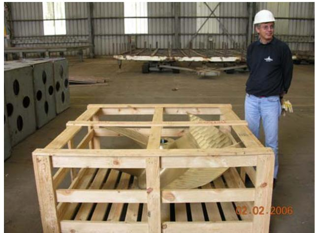
Der eigentliche Bugstrahler und die Schraube werden in der Schiffbauhalle auf den Einbau vorbereitet. Vor dem Einbau muss er in drei Komponenten zerlegt werden, damit er durch die Luke passt.
