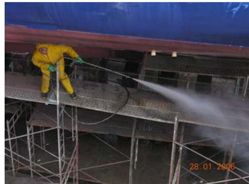
Vor dem Malen wird das Schiff von außen gereinigt. Selbst aus den kleinsten Ecken müssen die Seepocken entfernt werden, damit der neue Anstrich hält.
