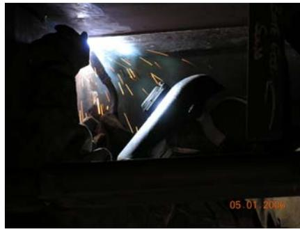
24 Stunden am Tag wird an der Unterwasserkonstruktion für die neuen Echolotschwinger gearbeitet. Links ist der Ausschnitt für den einen Meter breiten und acht Meter langen Sendeschwinger des Tiefseefächerlotes zu sehen. Über den gesamten Bereich darf sich die Konstruktion um maximal einen Millimeter verziehen. Um dieses zu gewährleisten wird jeder Schritt penibel ausgeführt und das Ergebnis optisch kontrolliert.
