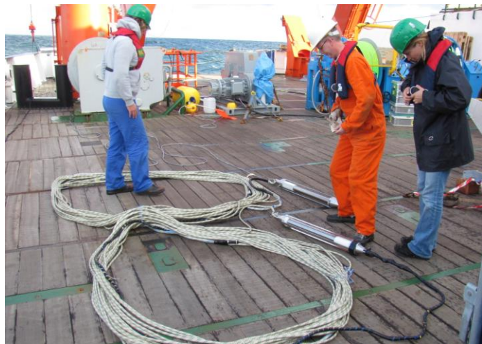
Abb 1: Vorbereitungen für den Test mit abgesetzten Empfängereinheiten mit Anker und Boje
