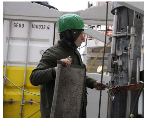
Abbildung 1: Erster Einsatz des Autoklavkolbenlotes (DAPC) im Poti Seep (links). Nach der Bergung der DAPC wird das untere Kernrohr abgenommen und der eigentliche Autoklav senkrecht aufgestellt, damit eine quantitative Entgasung nach oben einfacher ermöglicht wird. Ein kritisches Moment ist nach der Wegnahme der Schutzhülle die Ablesung des Druckes am Manometer (rechts). In diesem Falle ist es gelungen, den Meeresbodendruck von etwa 100 bar aufrecht zu erhalten.
