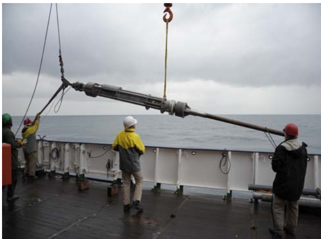
Abbildung 1: Erster Einsatz des Autoklavkolbenlotes (DAPC) im Poti Seep (links). Nach der Bergung der DAPC wird das untere Kernrohr abgenommen und der eigentliche Autoklav senkrecht aufgestellt, damit eine quantitative Entgasung nach oben einfacher ermöglicht wird. Ein kritisches Moment ist nach der Wegnahme der Schutzhülle die Ablesung des Druckes am Manometer (rechts). In diesem Falle ist es gelungen, den Meeresbodendruck von etwa 100 bar aufrecht zu erhalten.
