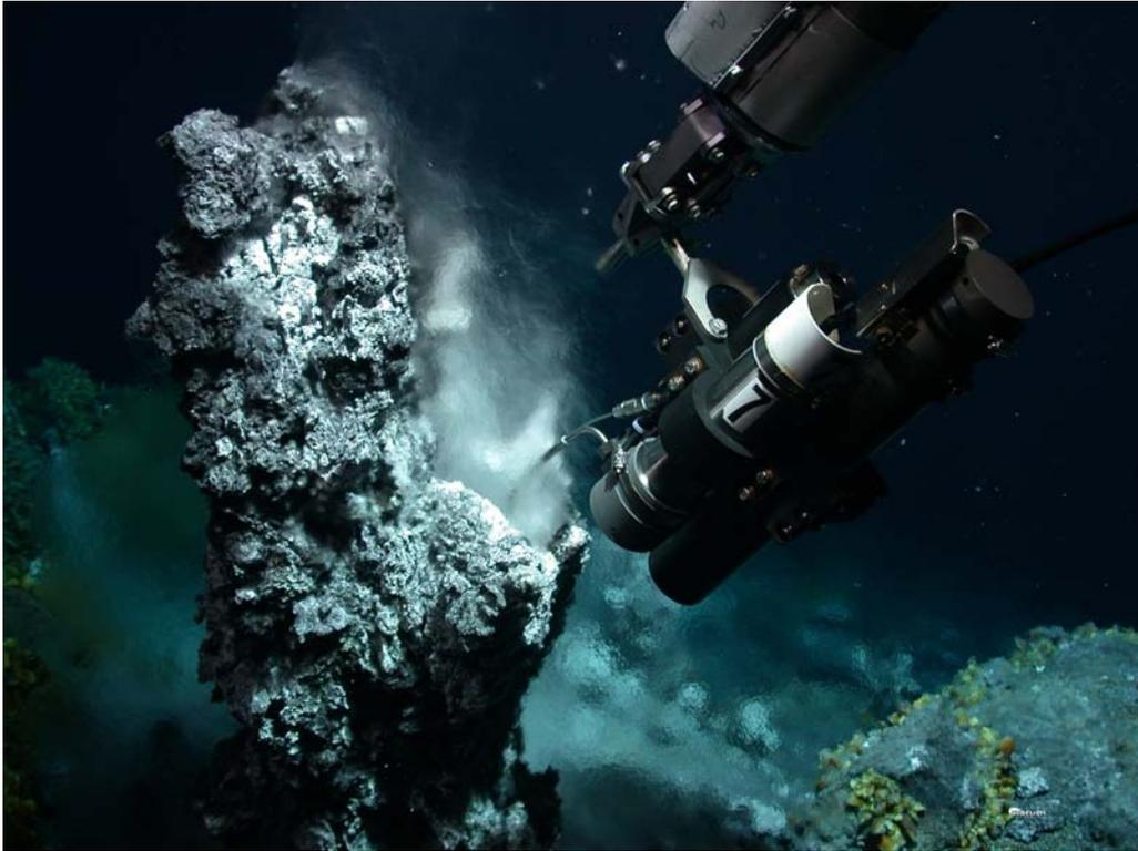
Beprobung der 300°C heißen Fluide eines weißen Smokers mit dem gasdichten Seewald Probenehmer
