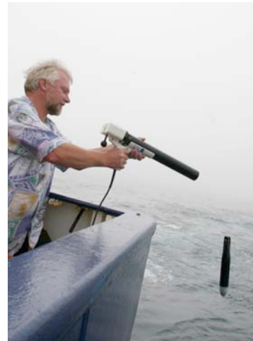
Ein ARGO Float wird steuerbord achtern zur Auslegung vorbereitet (links). Ein XBT wird backbord achtern abgeworfen (rechts)
