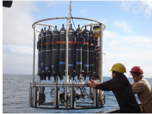
Während des CTD Profils werden die Protokolle zur Freon-Probennahme vorbereitet (links). Die Rosette mit den Wasserschöpfern, CTD (unten) und den LADCPs (gelbes Gehäuse) wird nach dem 54. Profil eingeholt (rechts)
