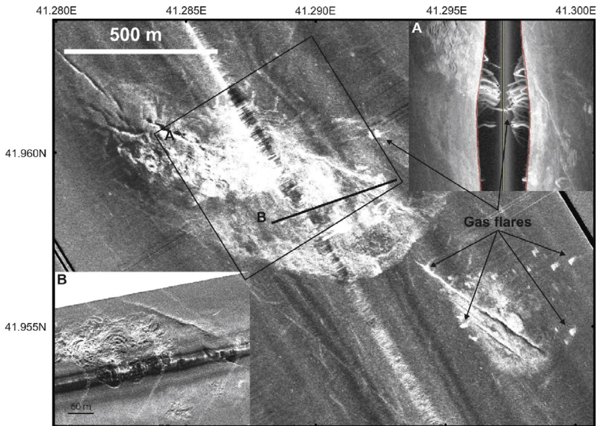
Abb. 7 Mosaik der Sidescan Sonar-Vermessung mit DTS-1 (75 kHz) im Batumi Seep -Gebiet. Hohe Backscatterintensität wird durch hellen Grauton angezeigt. A: Unprozessierte Sidescan-Sonar-Daten zeigen akustische Anomalien in der Wassersäule (Gasblasenaustritte). B: 410 kHz-Aufzeichnung im zentralen Seepbereich. (aus Klaucke et al. 2006, Marine Geology 231, 51-67)
