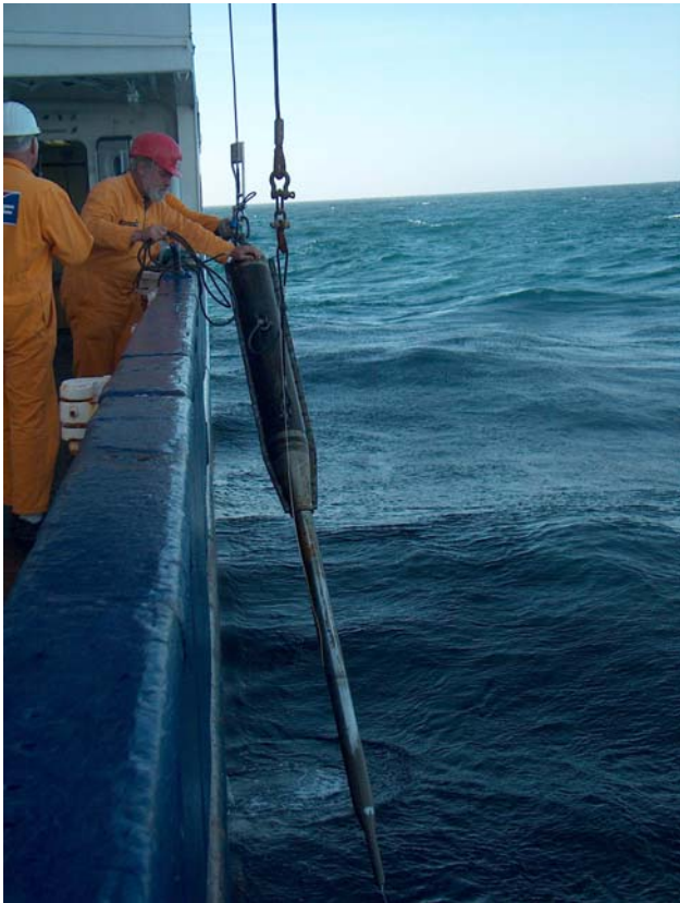
Abbildung 1 CPT-Messlanze des DFG-Forschungszentrums Ozeanränder Bremen beim Einholen.
