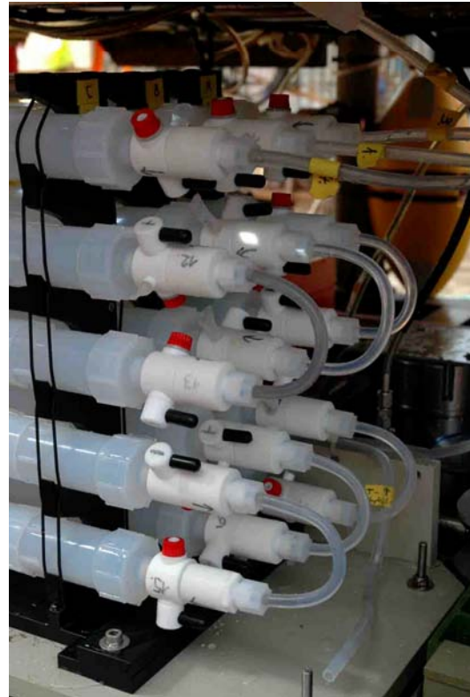
Abb. 1: Fluidsamplingsystem aus Teflon installiert am ROV
