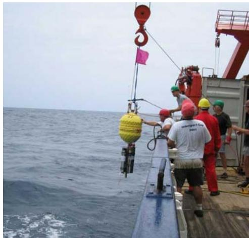
Abbildung 2: Aussetzung eines Ozeanboden Hydrophones
