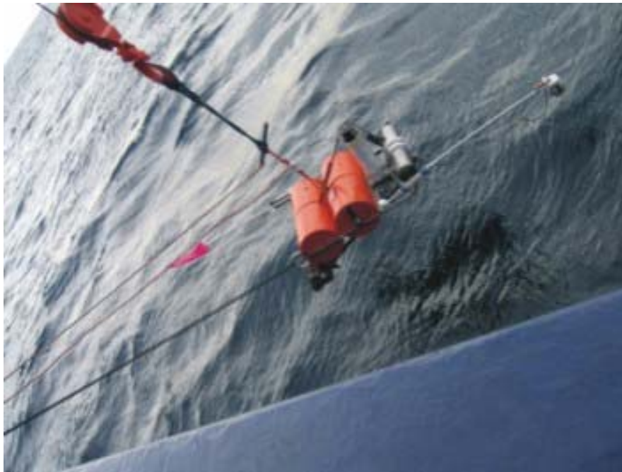
Abbildung1: Aussetzen des „Walze“ – Ozeanboden-Seismometers. Diese Instrumente sind so gebaut, dass sie flach auf dem Ozeanboden liegen, aber sich auch vertikal drehen können, wenn sie ausgelöst werden. Der Arm mit dem Geophon ist rechts zu sehen.
