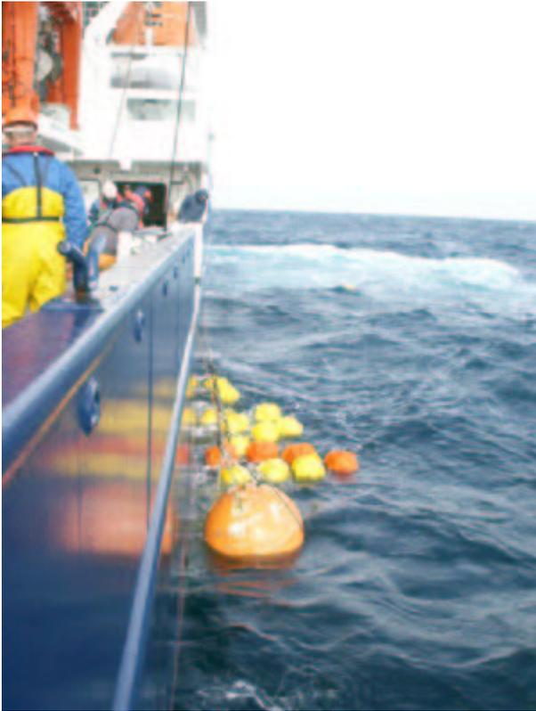
Wie tags zuvor wurden dann am Vormittag damit begonnen die zentrale Konvektionsverankerung (K61) zu bergen. Nach dem Auslösen wurde die Verankerung nach wenigen Minuten gesichtet und am Schiff festgemacht (siehe Foto). Dabei war schnell klar, daß das Topelement der Verankerung mit der Satellitenübertragung vollständig abgerissen war. Die Verankerung und die zugehörigen Transponder konnten dann erfolgreich geborgen werden.
