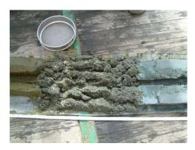
Abb. 1 Basales Konglomerat in Vibrocorerkern, links der darüberliegende Diatomeenschamm, rechts der darunterliegende blaugrüne Feinsand.
