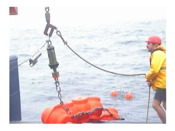
Beginn der B2 Verankerung. Im Wasser ist die Kopfboje mit Sender und Blitzlicht zu sehen. Da die Kopfboje in ca 3600m Tiefe hängen wird, konnte nicht die sonst übliche Konstruktion benutzt werden. An der Heckslippe sind die Auftriebskugeln zu sehen, rechts vom Haken kann man den akustischen Strömungsmesser erkennen, der T-S Sensor ist am Draht angeklemmt.
