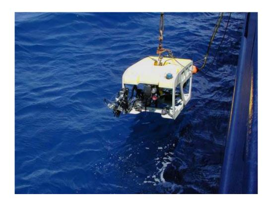
Das ROV wird SW von Gran Canaria für Balance-, Fahr- und Tauchtests zu Wasser gelassen (Foto G. Ruhland, MARUM).
