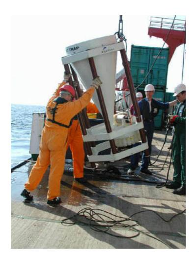
Sedimentfalle der Verankerung CI14 bei ESTOC wieder an Deck
