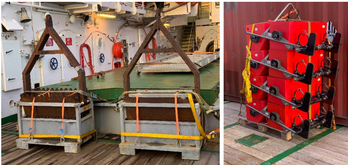
Abb. 2. Vorbereitung der Dredgen und der Ozeanbodenseismometer (OBS)
