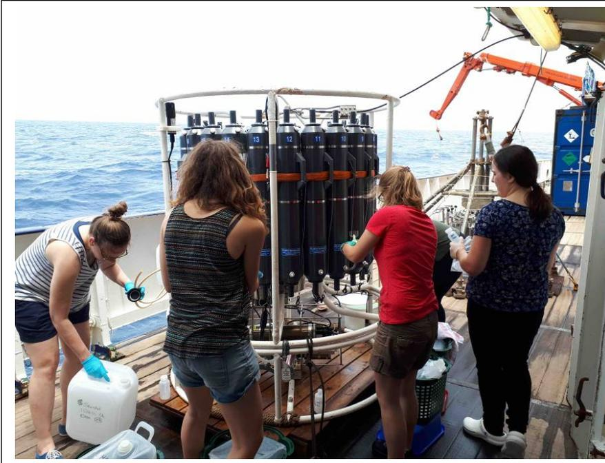
Die schiffseigene CTD-Rosette liefert die Wasserproben für viele Gruppen zur Bestimmung von Nährstoffen, gelöstem Sauerstoff, DOM und anderen Komponenten zur Analyse in den Heimatlaboren. Proben für die meisten Spurenmetalle werden dagegen ausschließlich mit dem Fisch und der spurenmetallreinen CTD-Rosette gewonnen.
