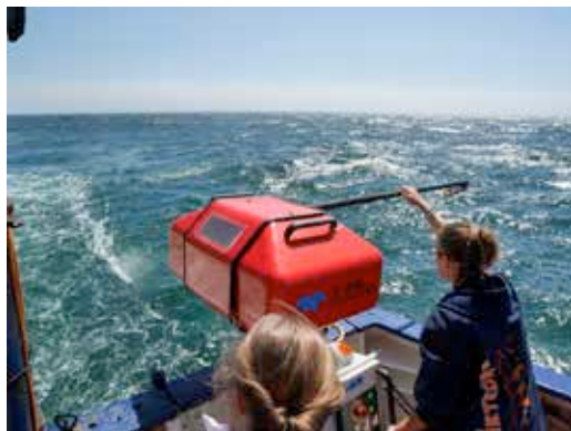
Die RapidCast Winde am Heck der METEOR spult die Leine der U-CTD Sonde ein.
