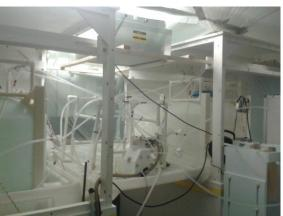
Reinraumzelt in der Luke der Meteor mit den beiden 500 Liter Tanks zur Aufnahme der Referenzproben (rechts). Am oberen rechten Bildrand ist der Luftfilter erkennbar, der Schmutzpartikel ausfiltert und außerdem die beiden Tanks und das Schlauchsystem, über die Referenzproben eingepumpt und homogenisiert wurden.
