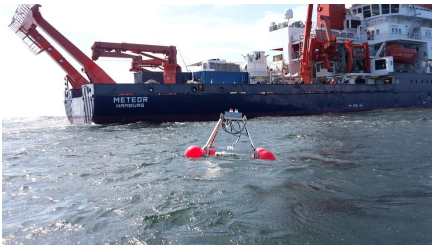
Abb. 3 (oben): Boje zur Messung von CO 2 Gasaustauschraten.
