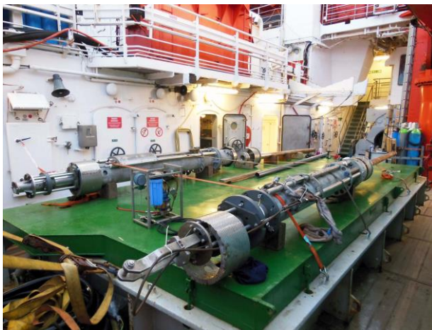
Abbildung 3: Die beiden Autoklavkolbenlote warten auf der Luke der METEOR auf ihre Einsätze.
