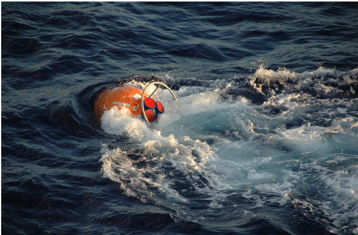
**Abb. 3:** Nach dem Werfen des Ankers fahren wir oft mit dem Schiff zurück entlang des Verankerungsdrahtes, um das Abtauchen der einzelnen Elemente beobachten zu können. In dieser Zeit wird die Verankerung mit bis zu 8 km/h durchs Wasser gezogen. Hier ist das oberste Element der Verankerung kurz vor dem Abtauchen zu sehen, das mit einem akustischen Strömungsmesser ausgerüstet in den nächsten 1.5 Jahren Strömungsschwankungen im Nordbrasilstrom aufzeichnen soll (Foto: Michael Schneider).
