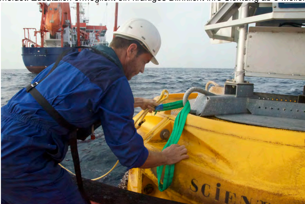
Abb. 1. Boje “Carmen“ wird an einer der Schlepplein der Maria S. Merian befestigt.
