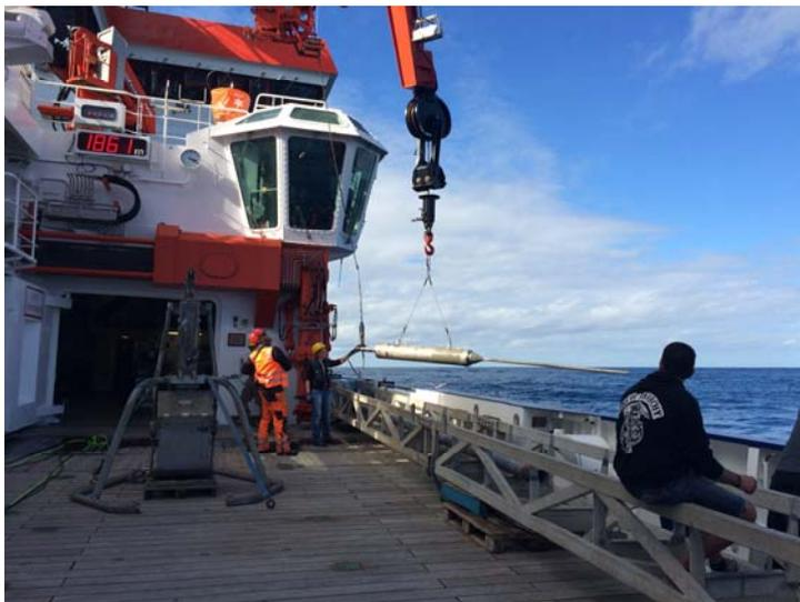
Abb. 3: Aussetzen der CPT-Lanze
