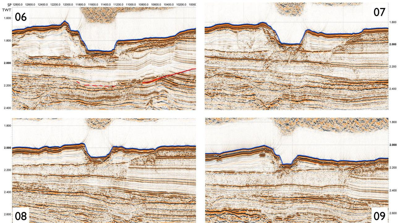
Abbildung 1: Die longitudinale Entwicklung eines Canyons auf dem Donaufächer. Mit zunehmender Wassertiefe nimmt z.B. die Asymmetrie der Uferwälle ab und dann wieder zu. Das ist sehr ungewöhnlich.
