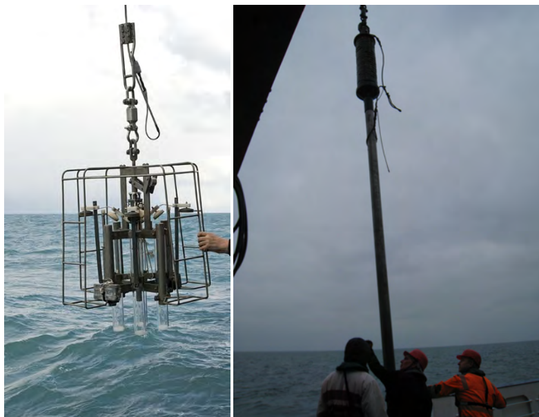
Ausbringen des Mini-Multicorers (links) und des Schwerelotes (rechts) .
